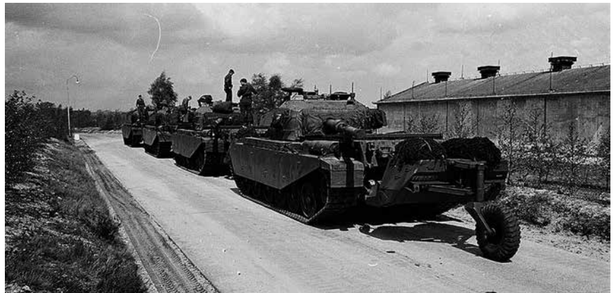
Fig. 12. Centurión con remolque de combustible. Fuente: Archivo Países Bajos.
