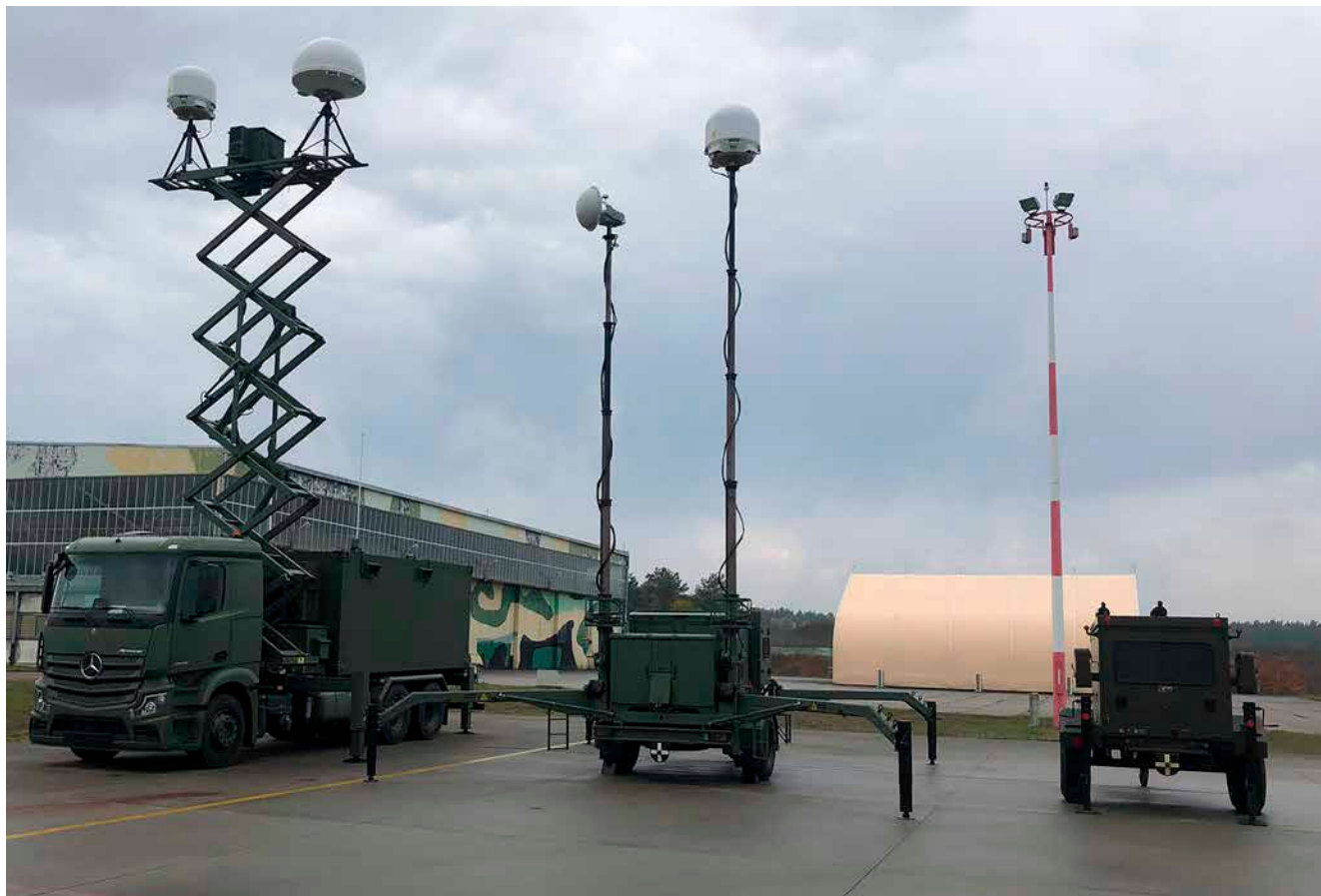
Estación terrestre de control de drones Bayraktar TB2
