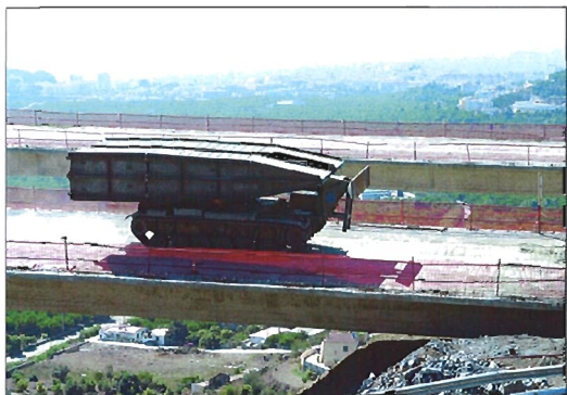
El VLP Tijera pasó por el viaducto a distintas velocidades
