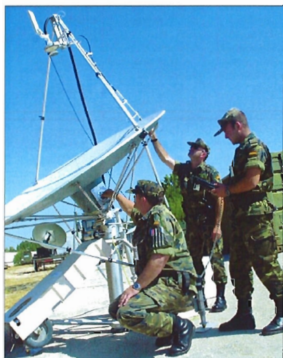
El sargento Millán —agachado— prueba la inclinación de la antena
