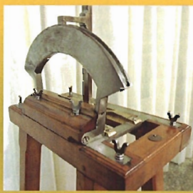
Máquina del Caballero D'Arcy (1783). Instrumento de laboratorio que permitía estudiar y comprobar empíricamente los resultados de la potencia de la pólvora en el interior de las bocas de fuego.
