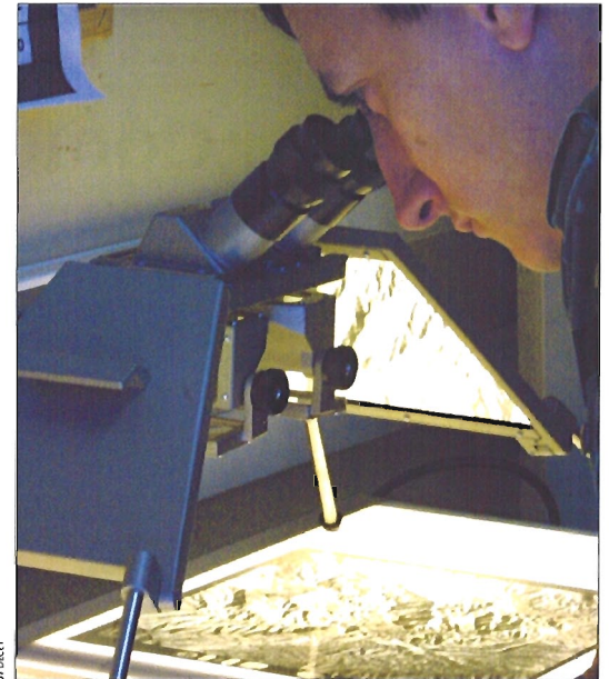
En el elemento Análisis llevan a cabo la interpretación fotográfica con —entre otros materiales— estereóscopos de espejos, como el de la imagen superior, y la preparan para su difusión con los plotter A0, en la imagen de la izquierda
