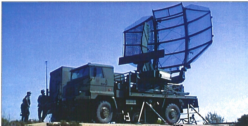
El radar de impulsos PAR, con un alcance de 110 kilómetros, proporciona detección a medias y grandes alturas
