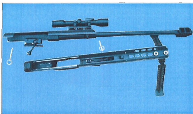
El fusil Barrett es un arma de acción de cerrojo, con cargador de cinco disparos y alza telescópica de 10 aumentos
