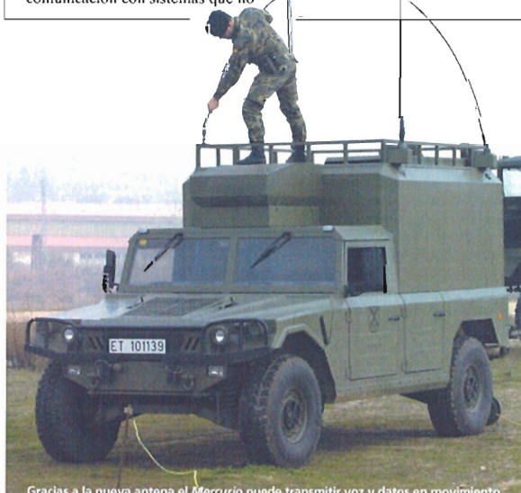
Gracias a la nueva antena el Mercurio puede transmitir voz y datos en movimiento
