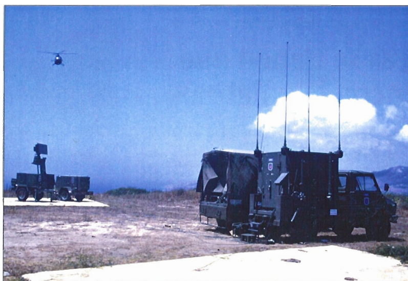
El radar RAVEN se sitúa junto a la Unidad de Control de Empeños que está dentro de un shelter
