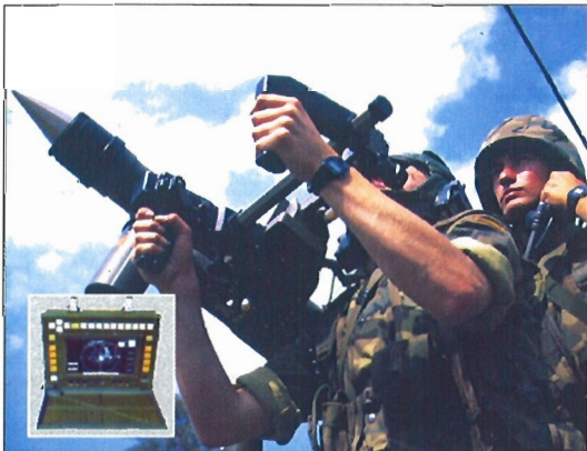
Cada puesto de tiro Mistral tiene un terminal inteligente (en el recuadro)
