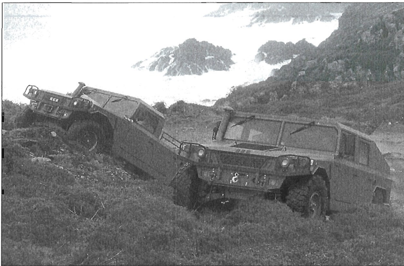
Su relación potencia/peso y un sistema de inflado automático permiten al Rebeco superar todo tipo de pendientes
