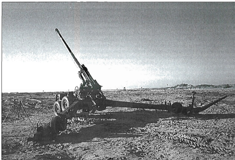
El obús ha sido desarrollado en poco más de un año sobre un prototipo de un obús de 155/39, realizado también en España
