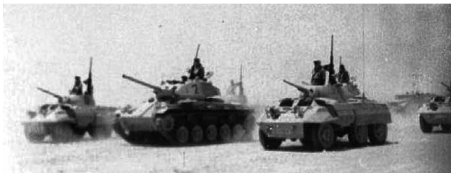
Los seis blindados de un escuadrón: 4 AAC y 2 M-24 (sólo uno visible) en secciones mixtas. Al fondo, en la polvareda, se adivina un semioruga de protección de una de las secciones
