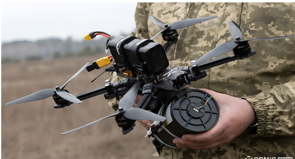
Ilustración 1. Dron FPV con sistema de comunicación por fibra. Fuente: Ministry of defense of Ukraine Creative Commons Attribution 4.0 International
