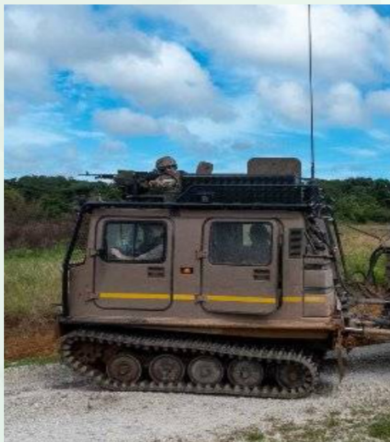
Figura 4. Vehículo articulado cadenas (VAC) HT 270 sustituye al BV 270 como vehículo de alta movilidad (VHM) específico para zonas montañosas, cubiertas de nieve (versión frío extremo) y pantanosas (versión tropicalizada)
