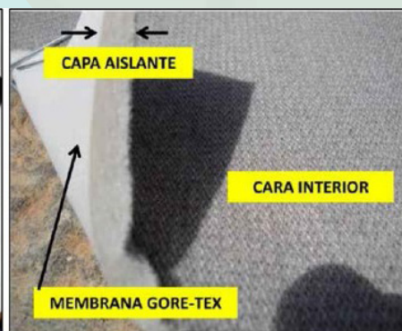
Imagen de la bota para frío de montaña (derecha.- detalle del forro interior aislante)
