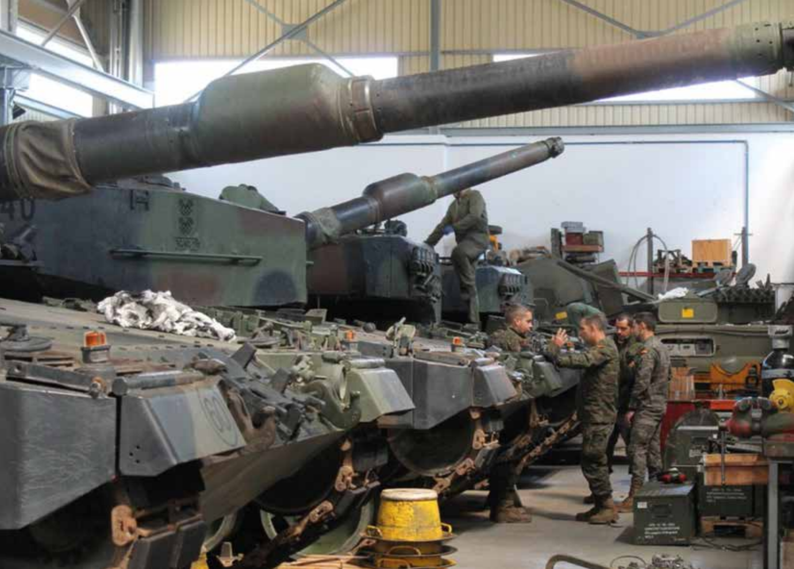
Personal de la UMM de la AALOG nº 21 (Sevilla) realizando tareas de tercer escalón de vehículos acorazados
