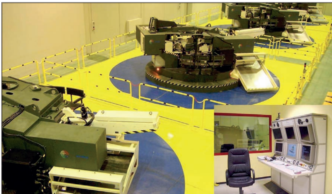
Simulador de la torre del carro de combate Leopard en el CIUACO (Centro de Instrucción de Unidades Acorazadas), San Gregorio (Zaragoza)
