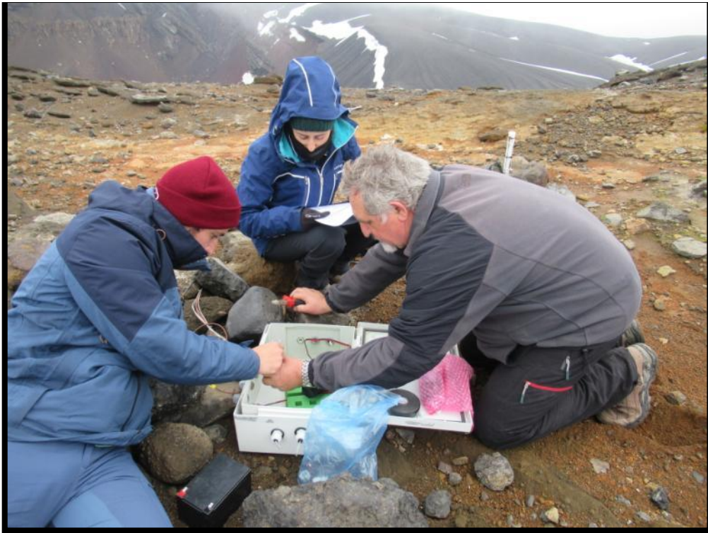
Instalación de la estación termométrica de Cerro Caliente
