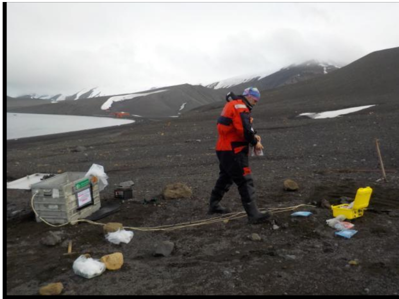
Colocando el array sísmico en Bahía Fumarolas
