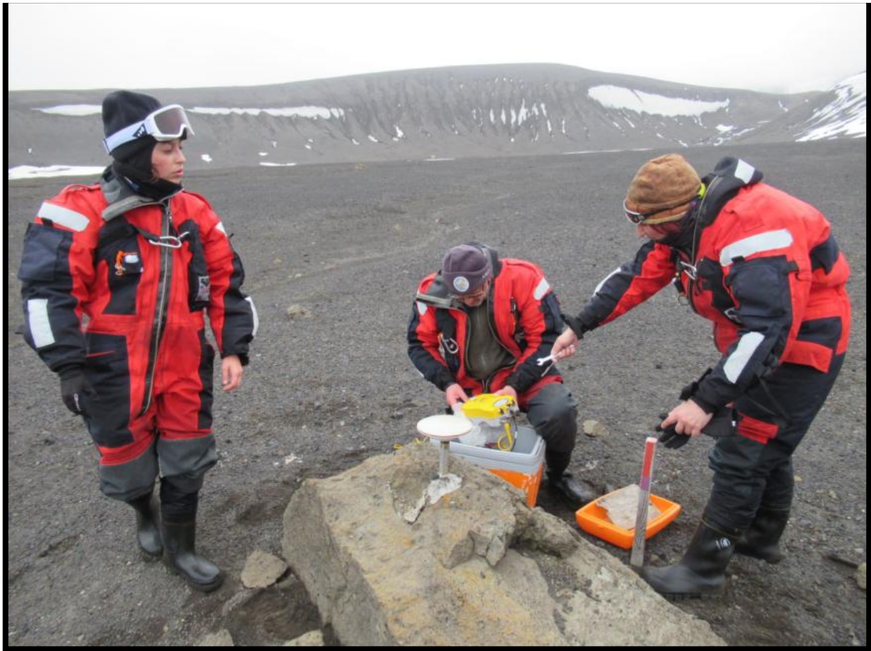
Instalación de un equipo GPS en una marca de nivelación en la zona de Cráteres del 70
