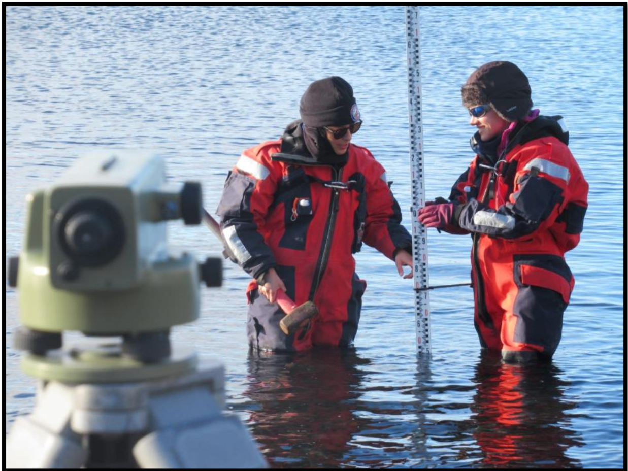
Apoyo topográfico a los mareógrafos de la estación DECMAR
