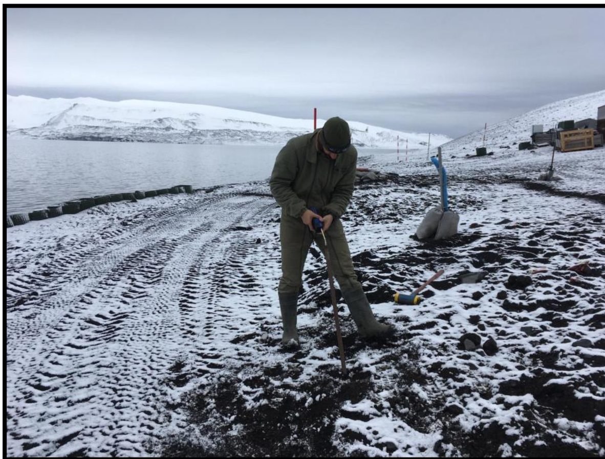
Realización de catas cerca de las fosas sépticas
