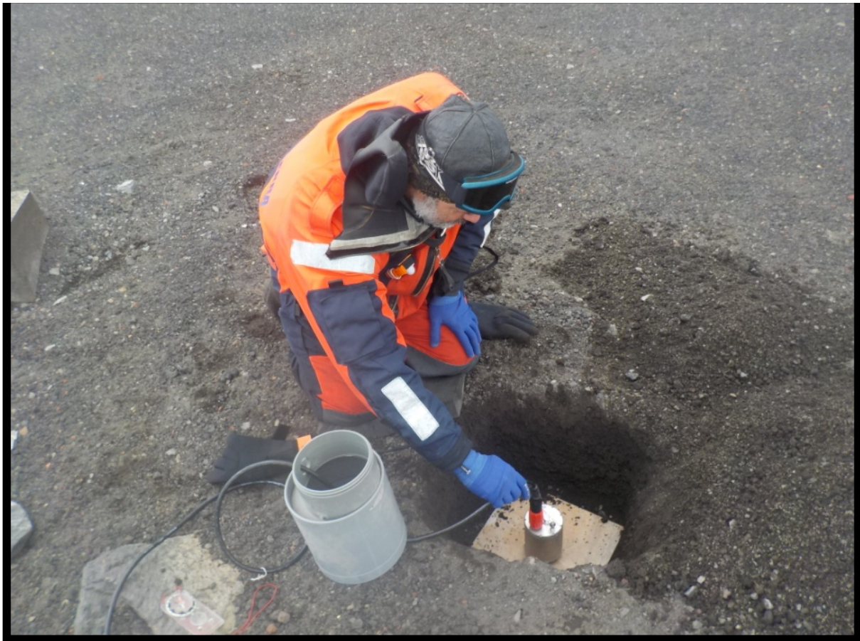
Imagen del array sísmico situado en Fumarolas
