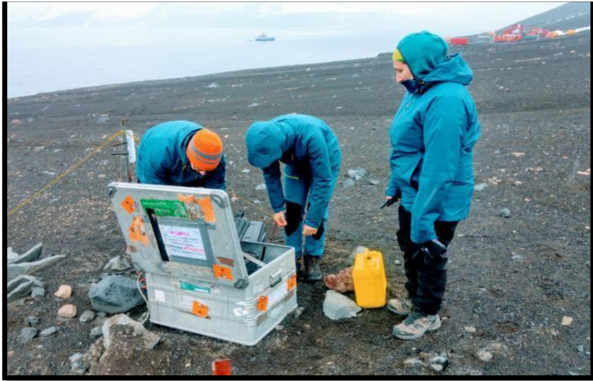
Parte del grupo del proyecto VIGILANCIA SISMOVOLCÁNICA realizando el cambio del sistema de adquisición en la estación sísmica BASE
