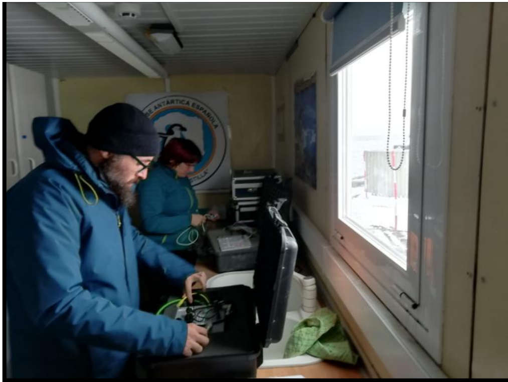
Preparación del sistema de adquisición para proceder a la sustitución en BASE
