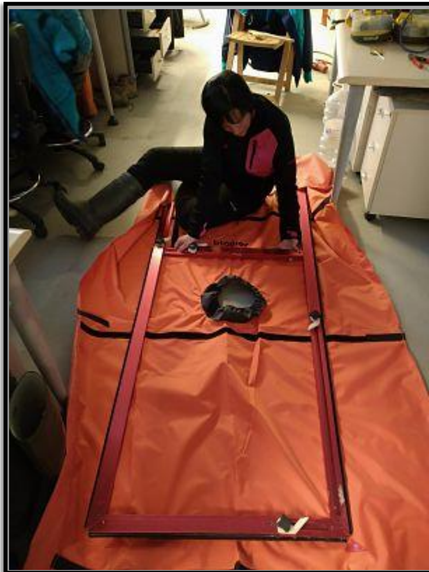
Puerta del blower-door test
