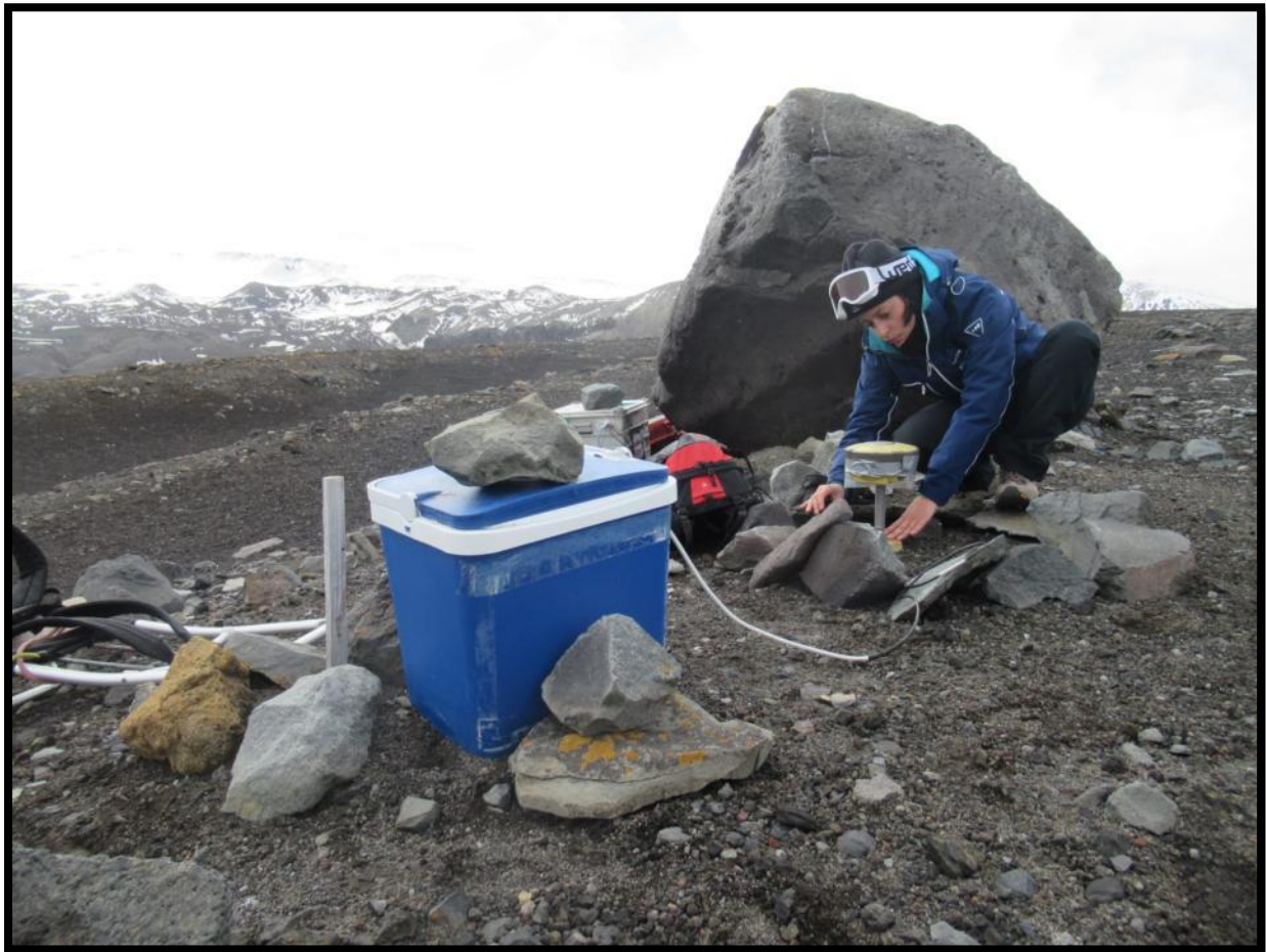
Instalación de un equipo GPS en la marca de nivelación L605
