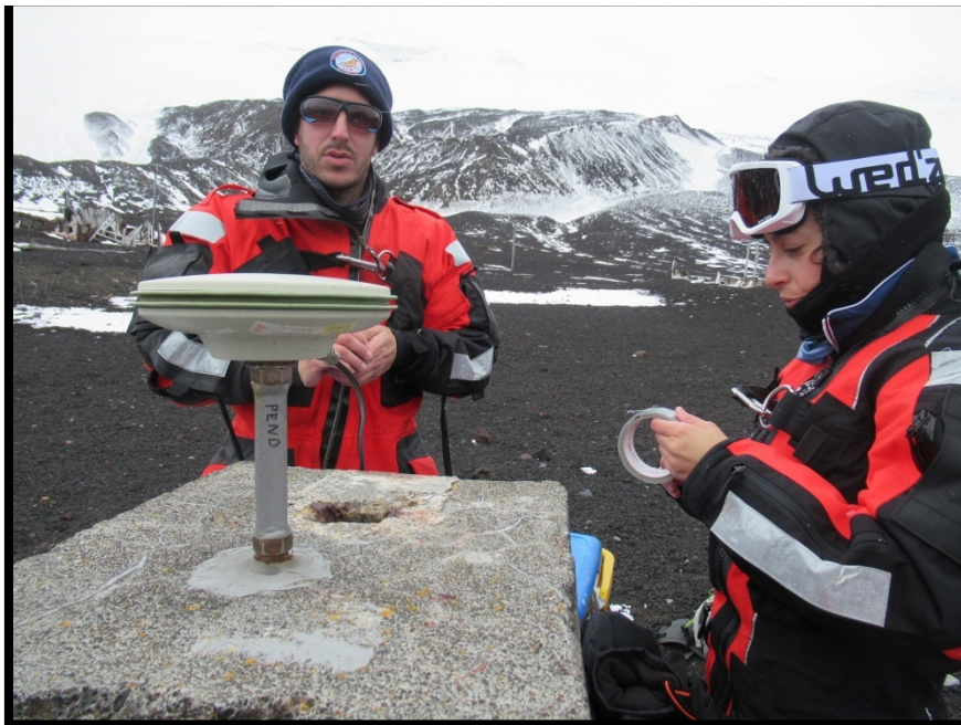
Colocación de un receptor GPS en estación
