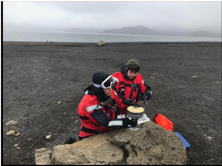
Retirada de un GPS situado en una marca de nivelación de Cráter 70
