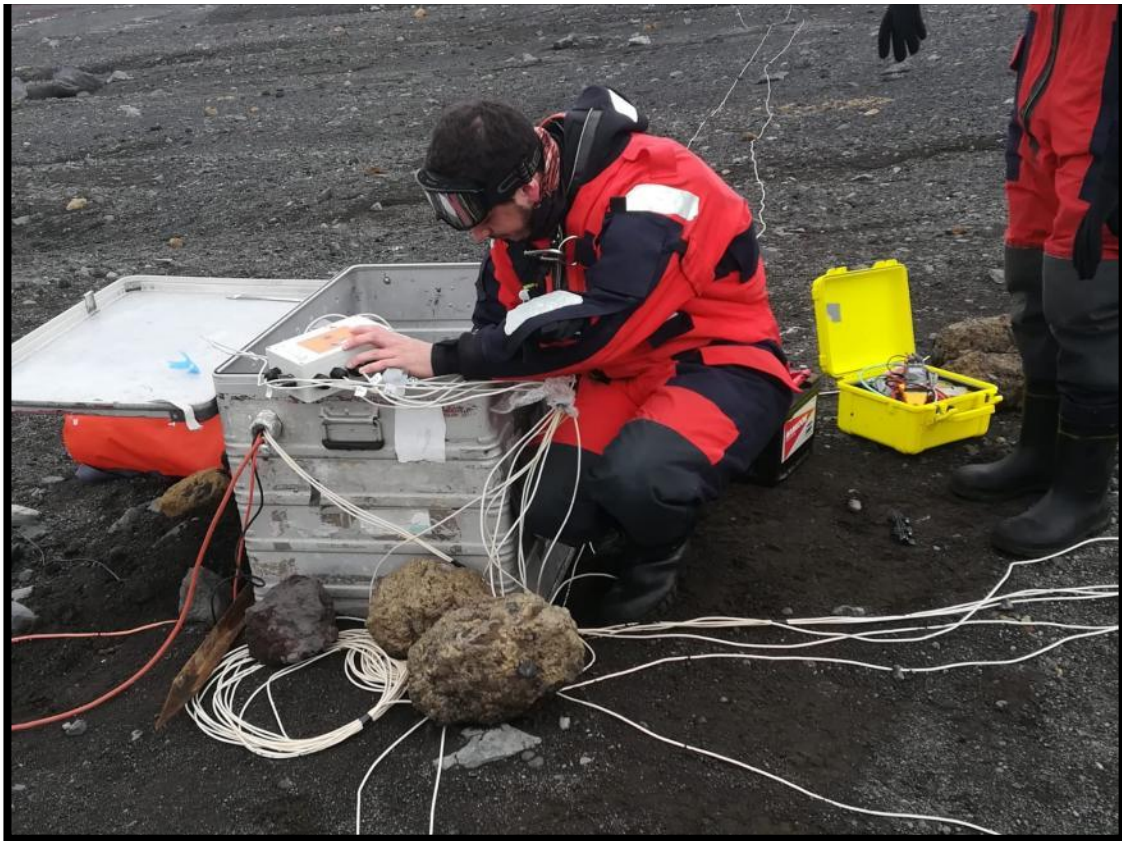
Trabajos de reparación en el sistema de adquisición que opera en la estación sísmica BASE
