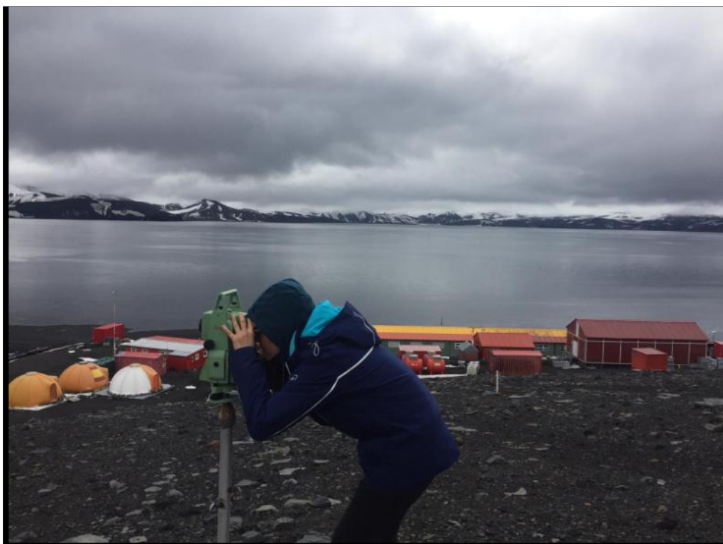
Científica tomando medidas con estación total hacia LAG2
