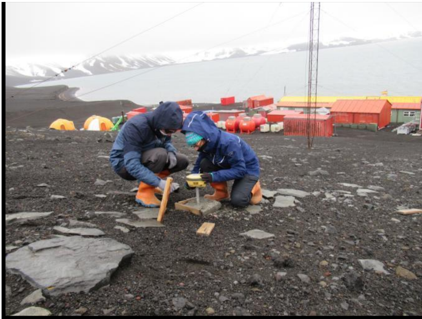
Localización y revisión de las marcas de nivelación
