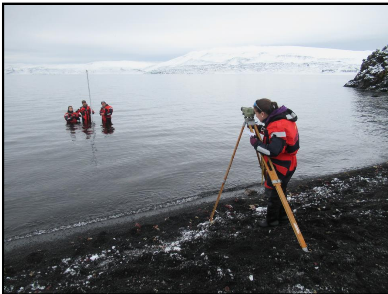
Apoyo topográfico a los mareógrafos fondeados en Colatinas
