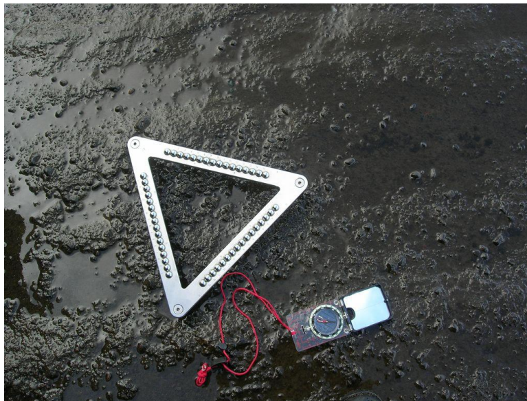
Equipo de medida de erosión de la experiencia TMEM
