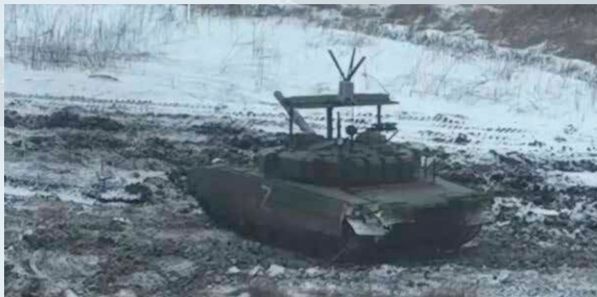
Sistema Saniya C-UAS instalado sobre un carro T-80BV
