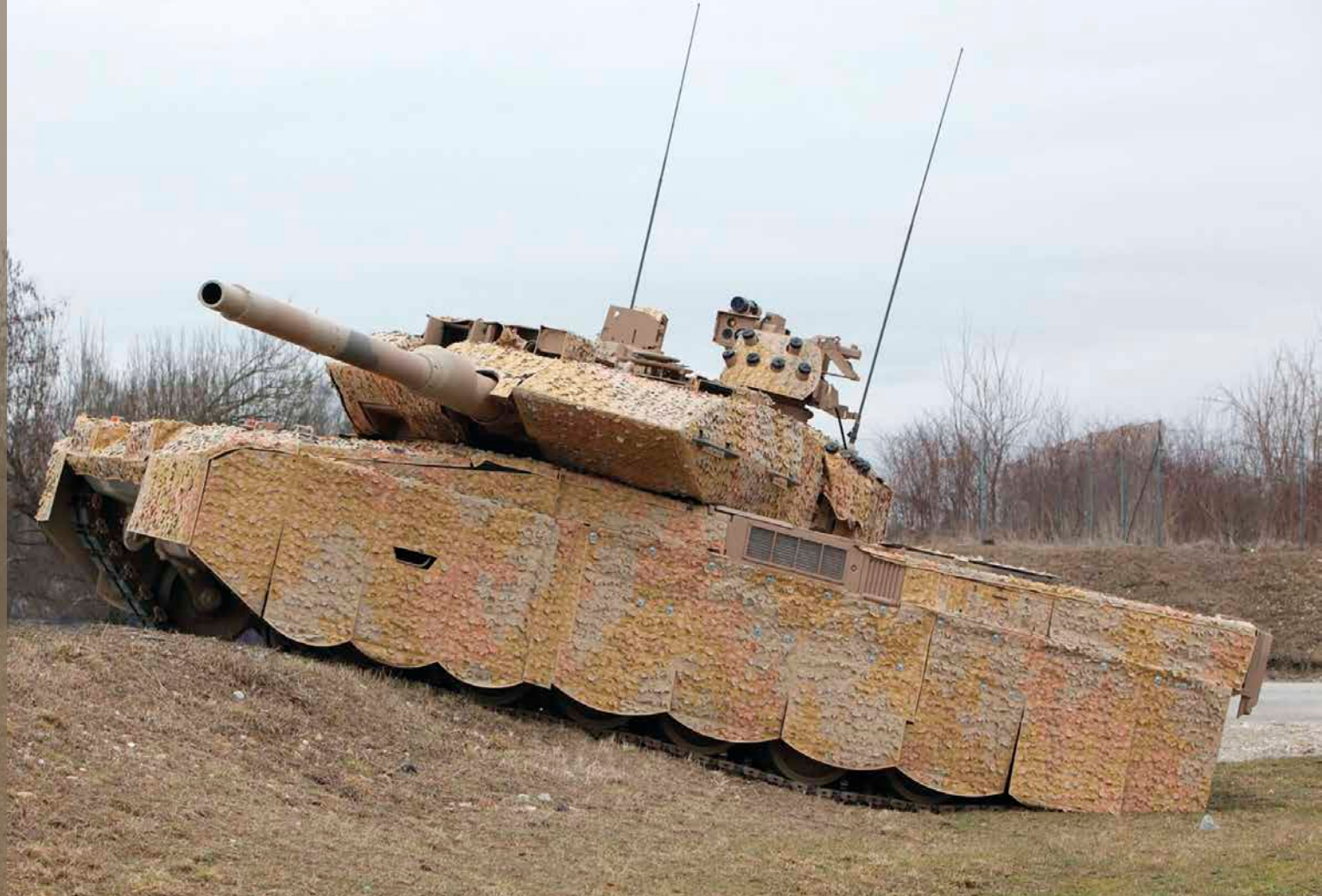
Red multispectral Barracuda en Leopard 2A7
