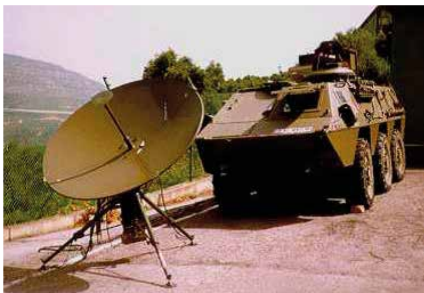
Estación Asturias sobre BMR
