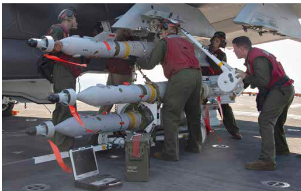
Colocación de bombas de guiado láser en un F-35B
