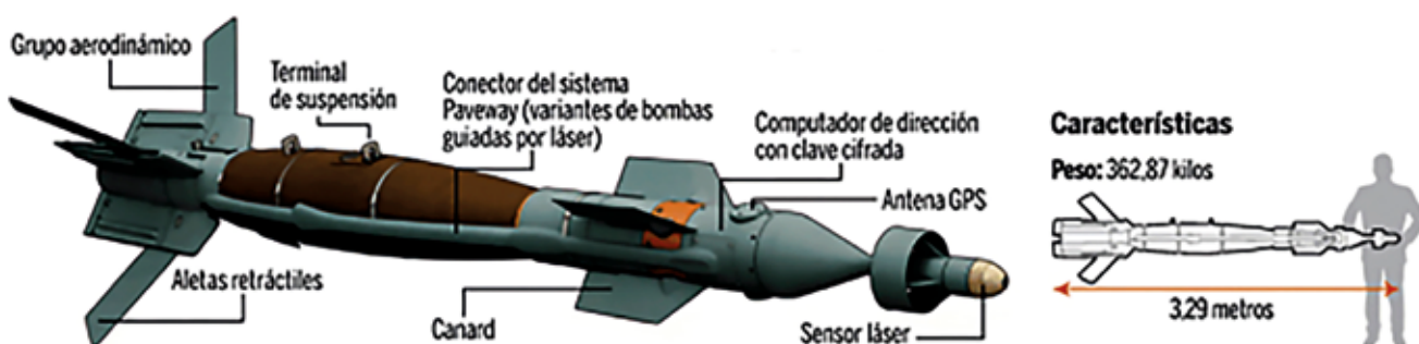
Figura 2. Esquema explicativo del kit Paveway
