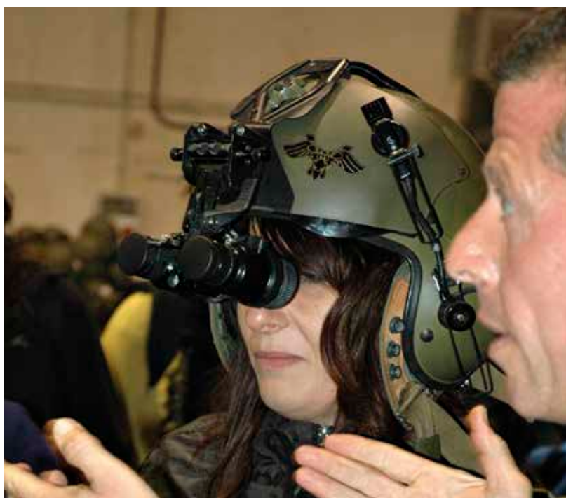
Prototipo de casco con GVN para los pilotos de las FAMET
