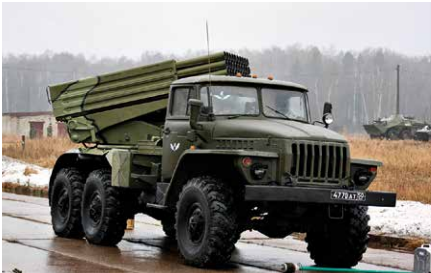
Lanzacohetes soviético modelo BM-21 «GRAD»
