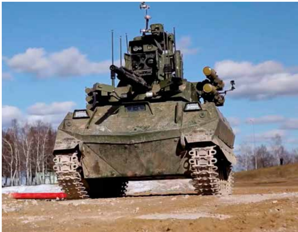
Sistema de Armas Autónomo ruso URAN-9
