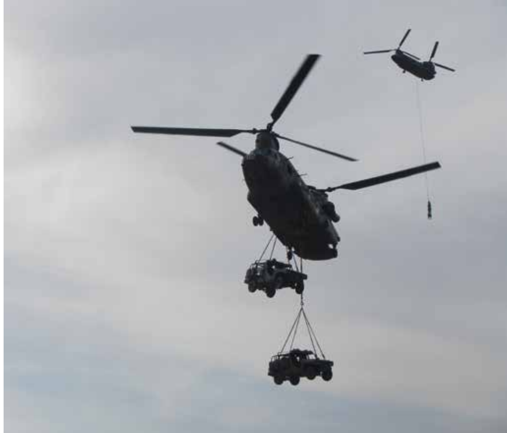
Helitransporte con vehículos de operaciones especiales
