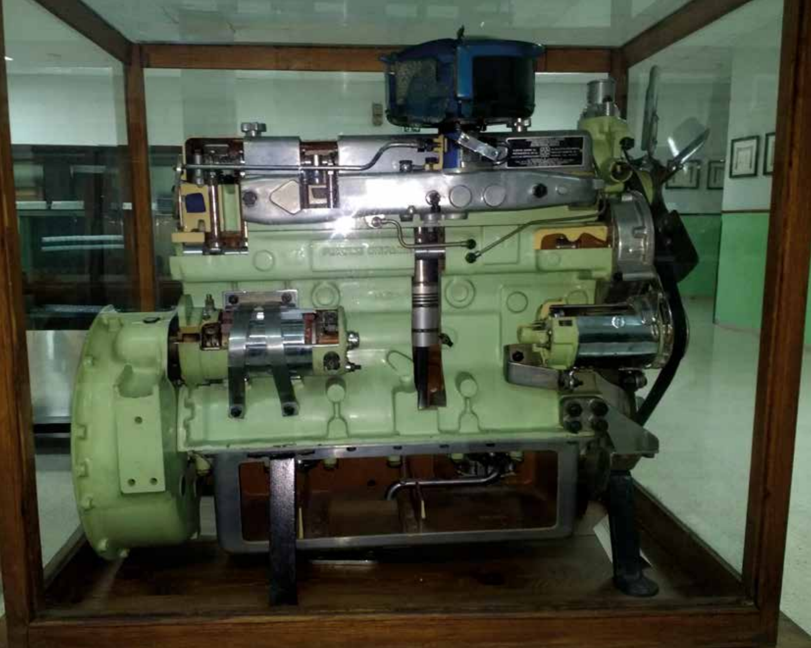
Motor diésel Perkins seccionado serie P
