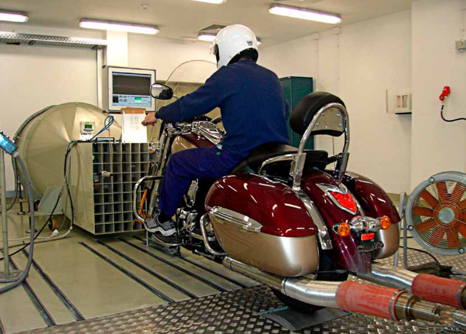
Ensayo de emisiones en motocicletas
