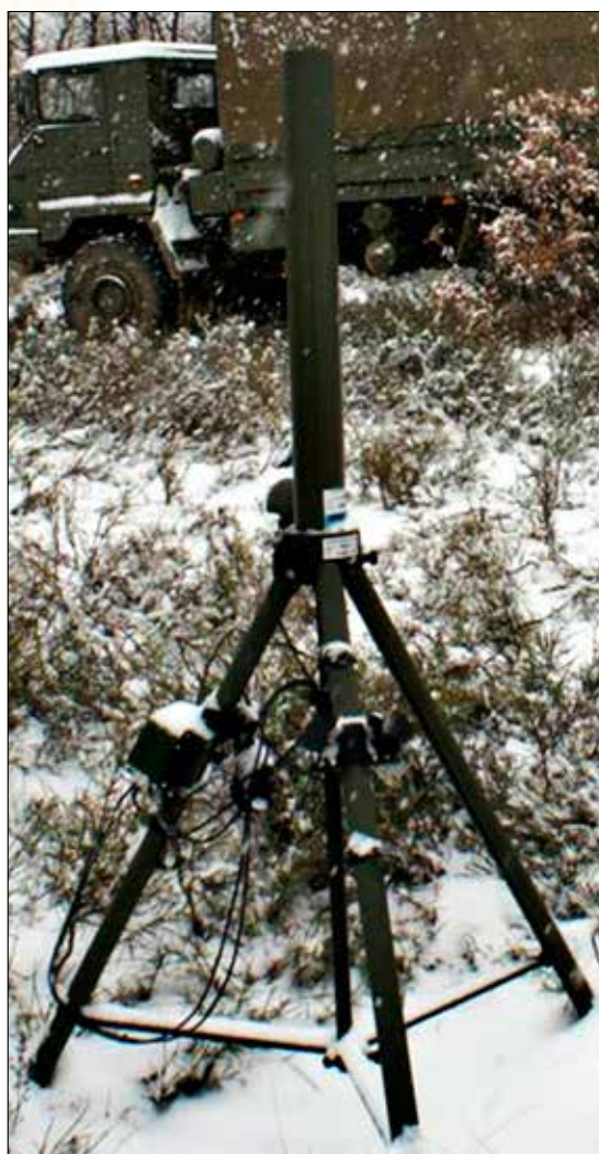
Estación meteorológica Marwin MW 32, con su antena omnidireccional
