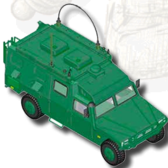
Diseño en 3D de instalación vehicular de PC de Bon en vehículo VAMTAC
