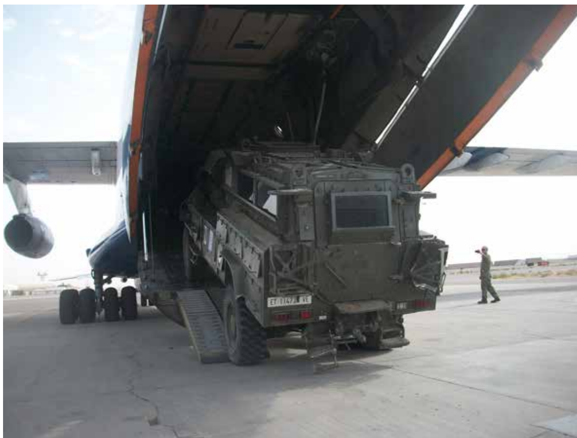
Carga de un vehículo RG-31 en un avión ILUSYN-76
