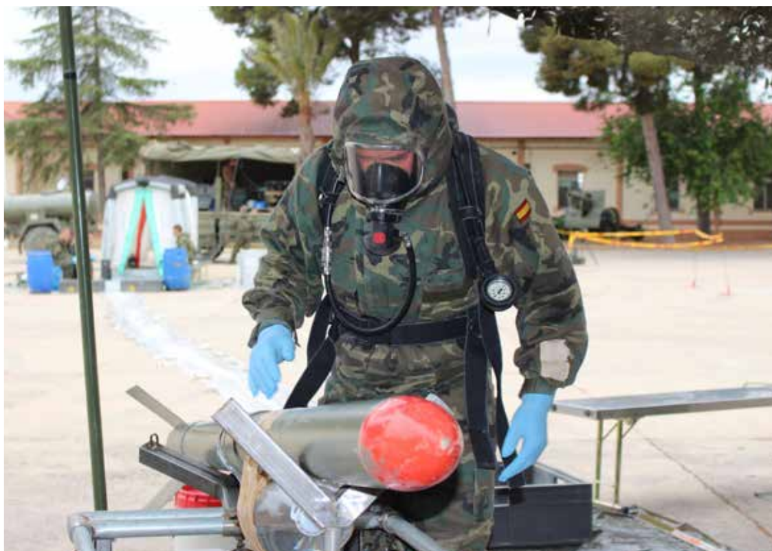
Operaciones CBRN-EOD. Verificación de la carga química de un proyectil desactivado
