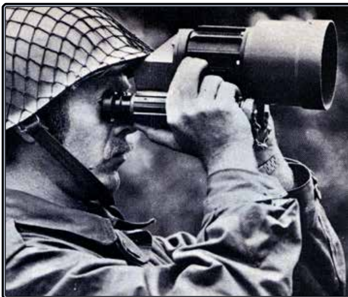
Binoculares para observación nocturna de vehículos hasta 1.500 metros
