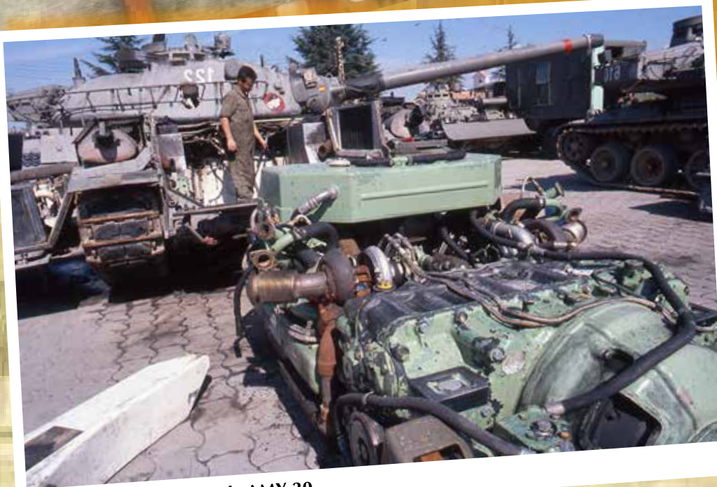
Sustituyendo un motor de AMY 30
