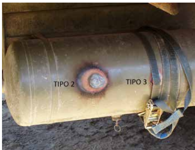
Reparación expeditiva tipos 2 y 3 de depósitos de fluidos
