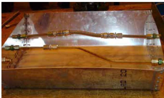
Reparación expeditiva tipo 1 de tuberías y canalizaciones de fluidos
