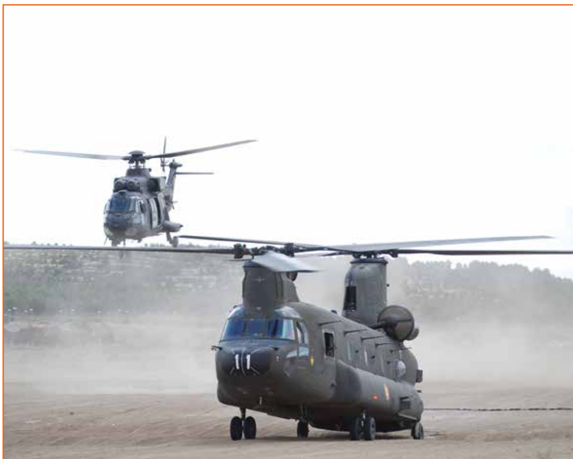
El HT-17 Chinook tiene la capacidad de establecer un puesto de repostaje móvil para otros helicópteros ( fat cow )
