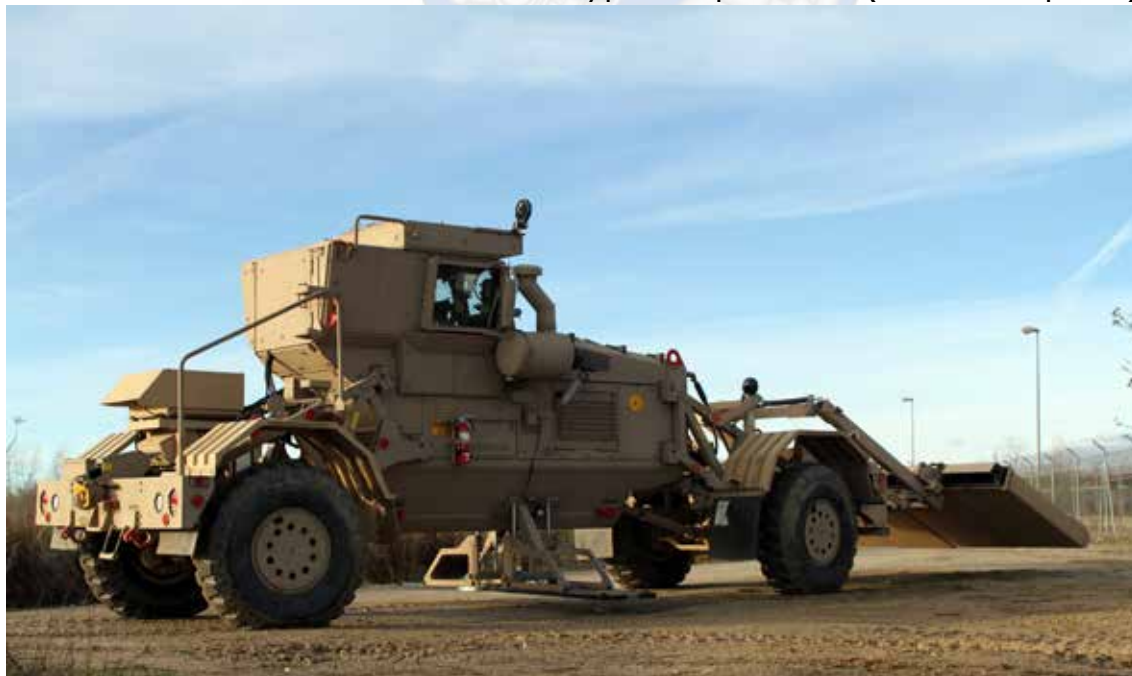
Vehículo Husky para la limpieza de rutas (de artefactos explosivos)
