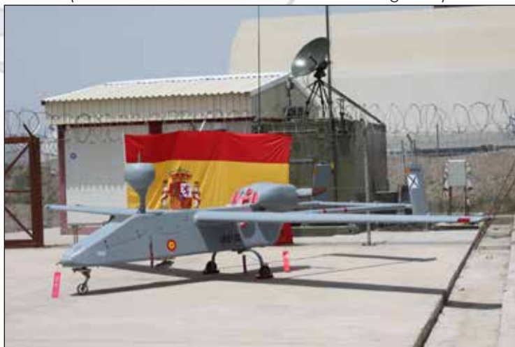
UAV PASI (Plataforma Autónoma Sensorizada de Inteligencia)
