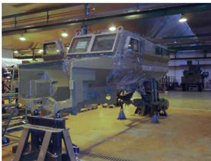
Vehículo RG-31 MK5E en reparación después de sufrir un IED en Afganistán
