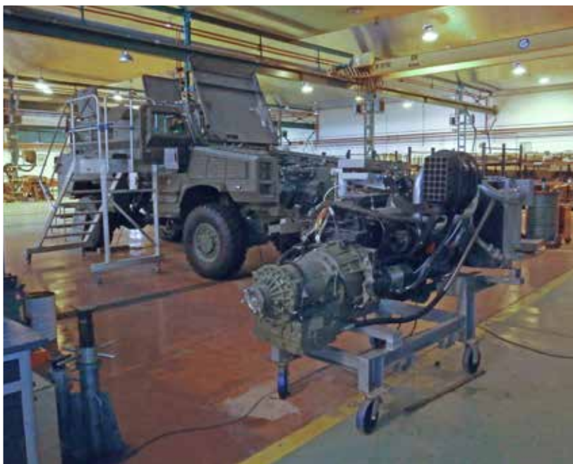
Grupo motopropulsor del vehículo RG-31 MK5E. Está compuesto de motor CUMMINS y caja de cambios ALLISON con versiones para aplicaciones civiles
