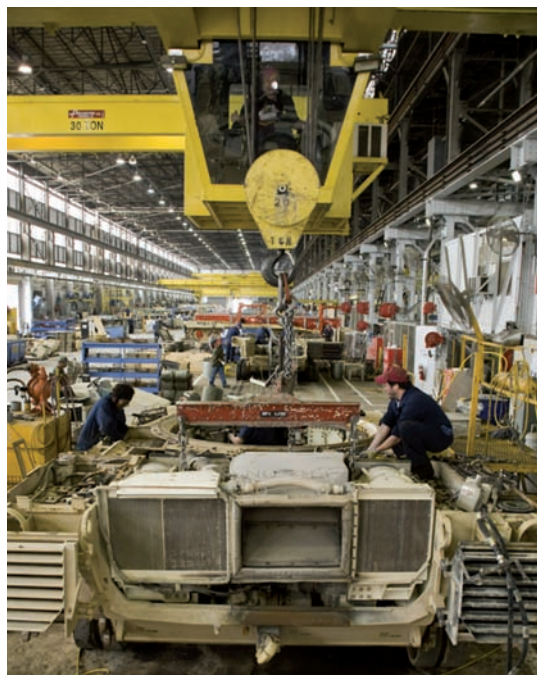
Cadena de montaje del M-1 Abrams
