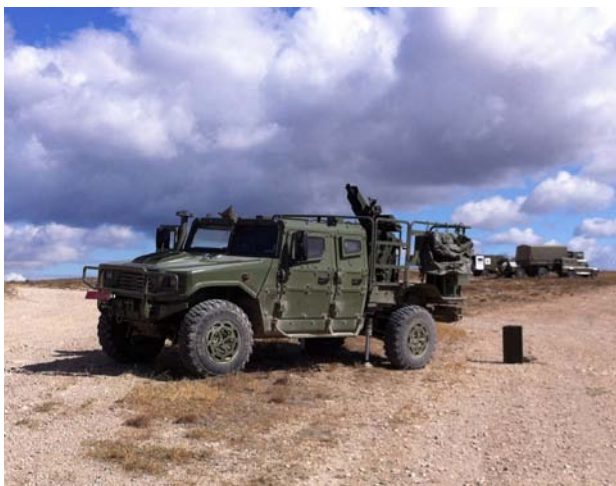
El sistema de mortero embarcado CARDOM (de la casa SOLTAM) sobre VAMTAC S-3
