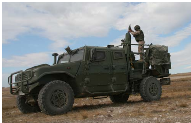
Para realizar la alimentación del arma los sirvientes deben abandonar la seguridad que proporciona la cabina blindada
