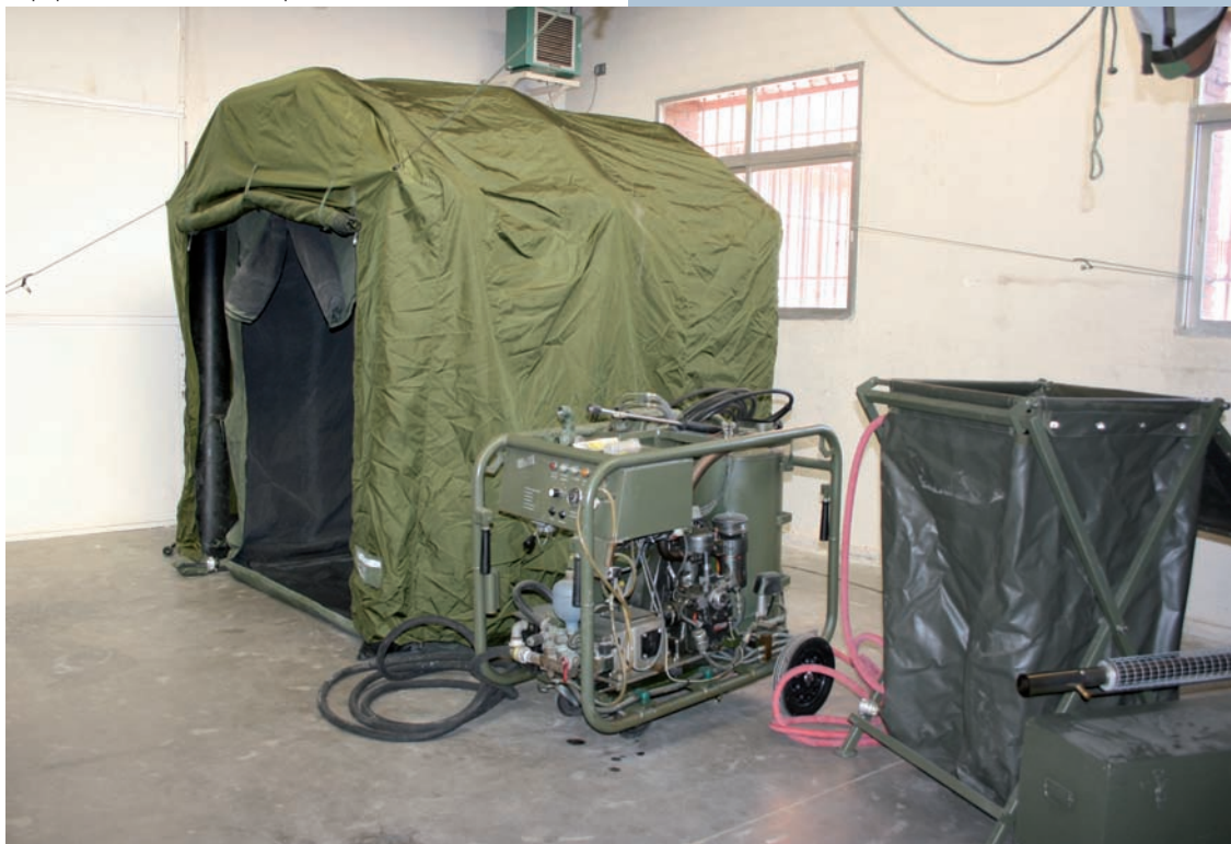
Equipo de desinfección por calor húmedo
