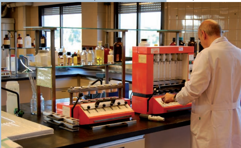
Determinación de macronutrientes de alimentos (grasas, proteínas, fibras, cenizas e hidratos de carbono) en la sección de análisis físico-químico
