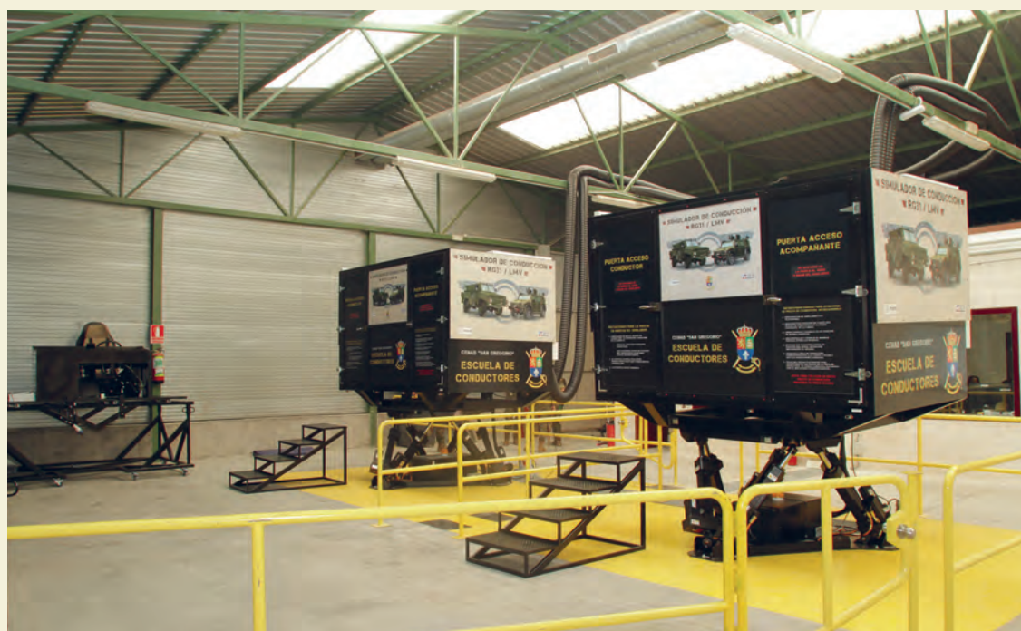
El simulador cuenta con dos cabinas que reproducen el movimiento de los vehículos
