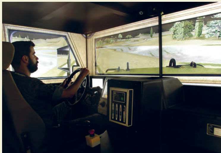
Cuatro pantallas simulan las lunas frontales y ventanas laterales
