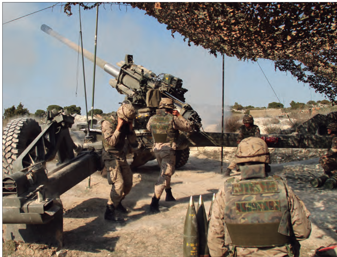
El obús de 155/52, con un tubo de más de 8 metros, puede efectuar hasta 10 disparos por minuto
