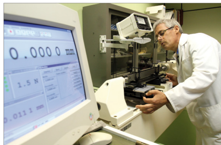
Calibración con una Máquina de 1 Coordenada Horizontal (M1CH)
