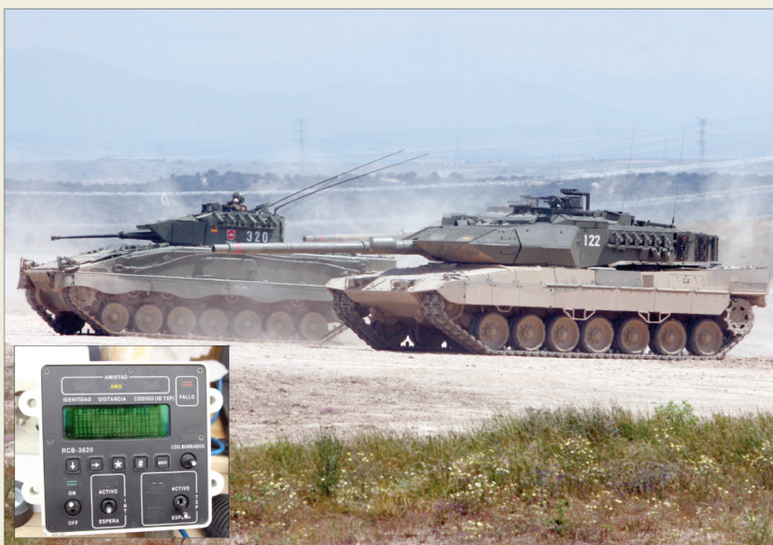
El dispositivo de identificación (abajo izquierda) se adaptará a vehículos como el Leopard o el Pizarro
