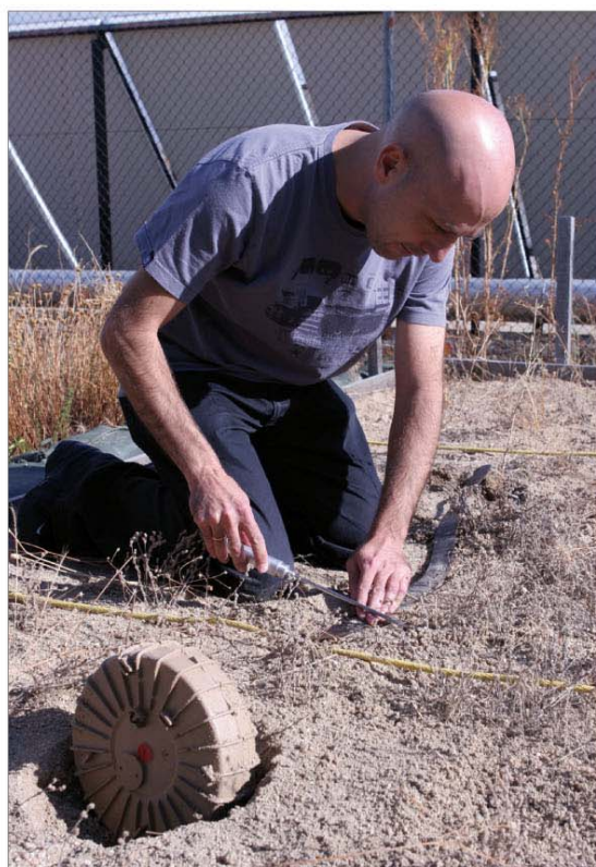
La técnica de sondeo permite que una persona pueda salir de un campo minado
