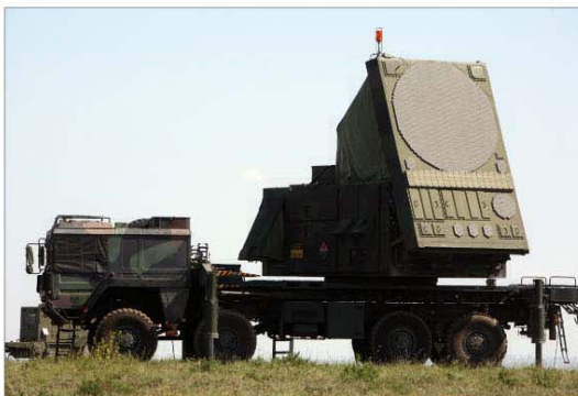
El radar del Patriot tiene un alcance aproximado de 150 kilómetros
