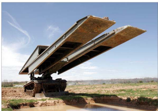
Uno de los materiales desplegados en Burgos fue el Vehículo Lanzapuentes
