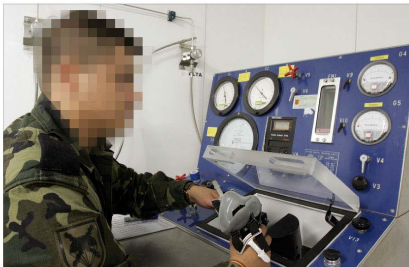
El taller de mantenimiento de equipos de respiración dispone de una máquina de pruebas Test Stand
