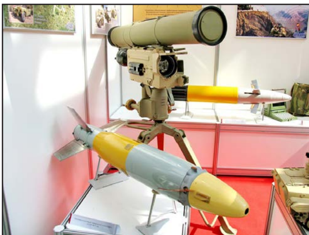
El sistema "Kornet" dispone de una guía por haz de láser codificado
