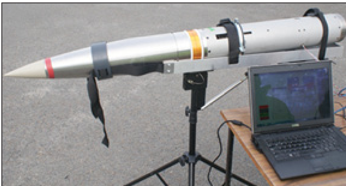
Kit MIURA equipado con ojiva de telemetría
