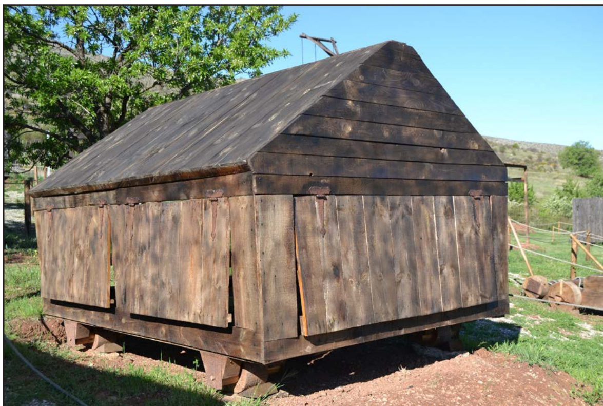
Reconstrucción de un musculo, máquina utilizada en el mundo romano para tapar la boca de las minas. Trebuchet Park, Albarracín.
