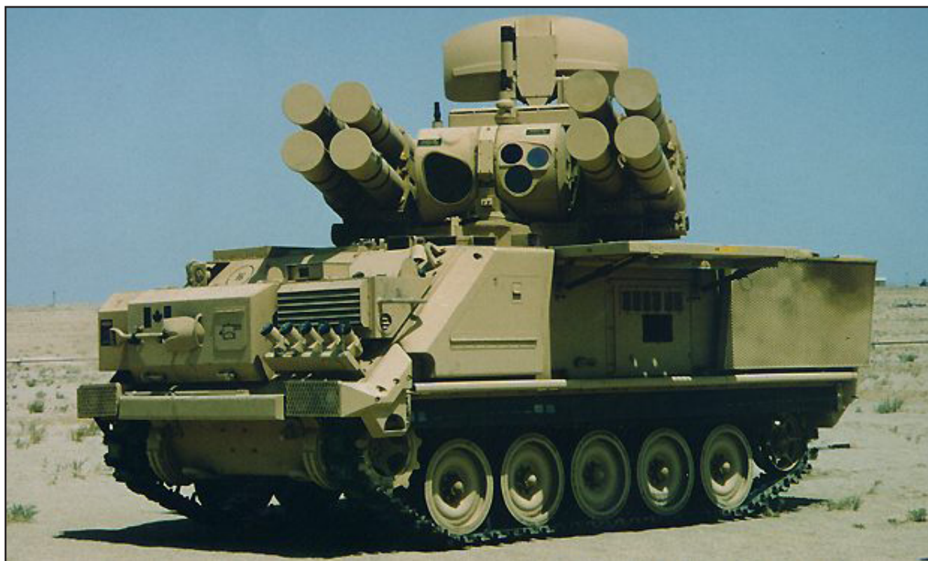
El "ADAST" es el único sistema operativo con capacidad dual antiaérea y contracarro
