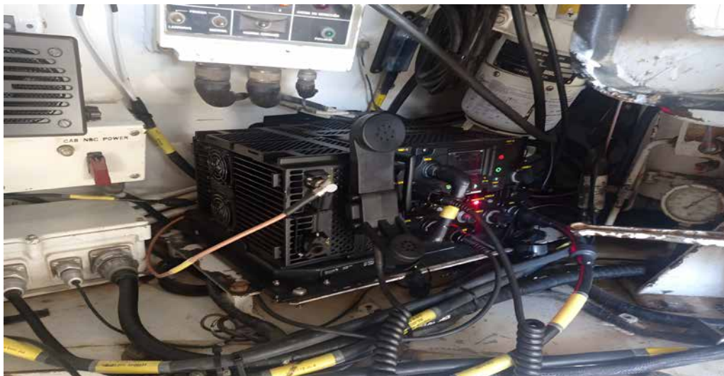
Ilustración 6. Radio ELBIT E-LynXT instalada en un obús M109-A5. Fuente: RACA 11.
