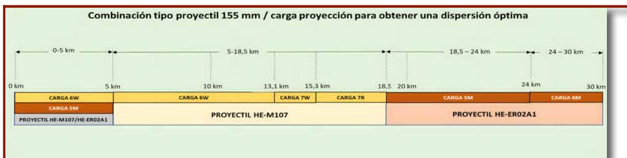
Figura 5. Combinación proyectil/carga para mínima dispersión con SIAC 155 mm. Fuente: autor
