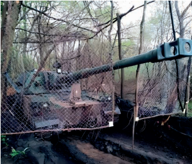
Utilización de redes metálicas como protección. Fuente: https://es.topwar.ru/224449-ot-rybolovnyh-setej-do-setki-rabicy-kak-ukraincy-pytajutsja-zaschitsja-ot-nashih-lancetov.html
