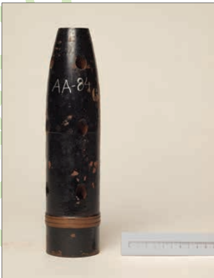
Figura 6. Proyectoil fumígeno de 6.5 cm para tiro contra globos AA-84.
