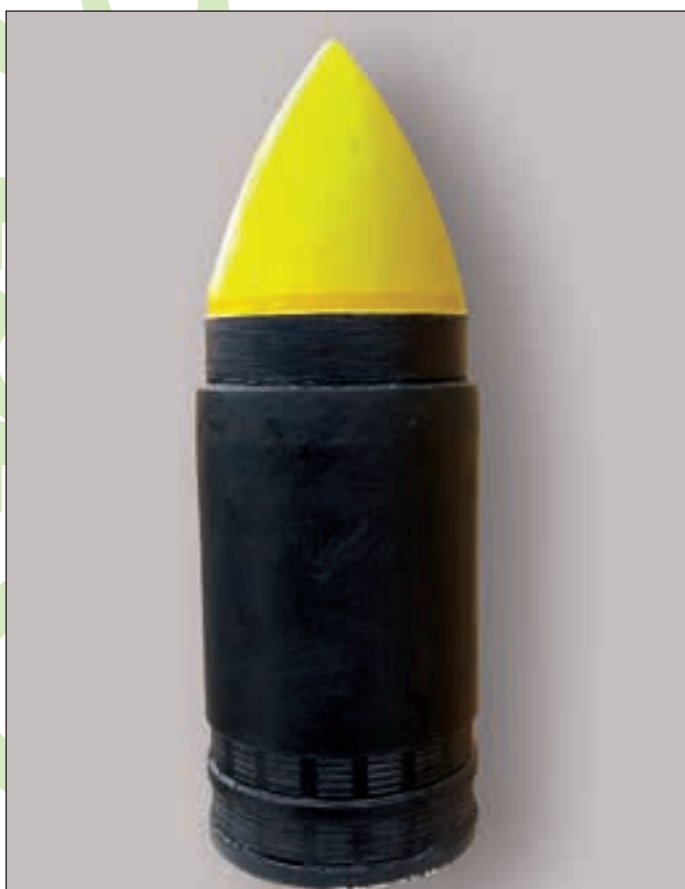
Figura 9. Proyectoil rompedor de 24 cm Spgr. L2,8 Bdz. (m. Haube).
