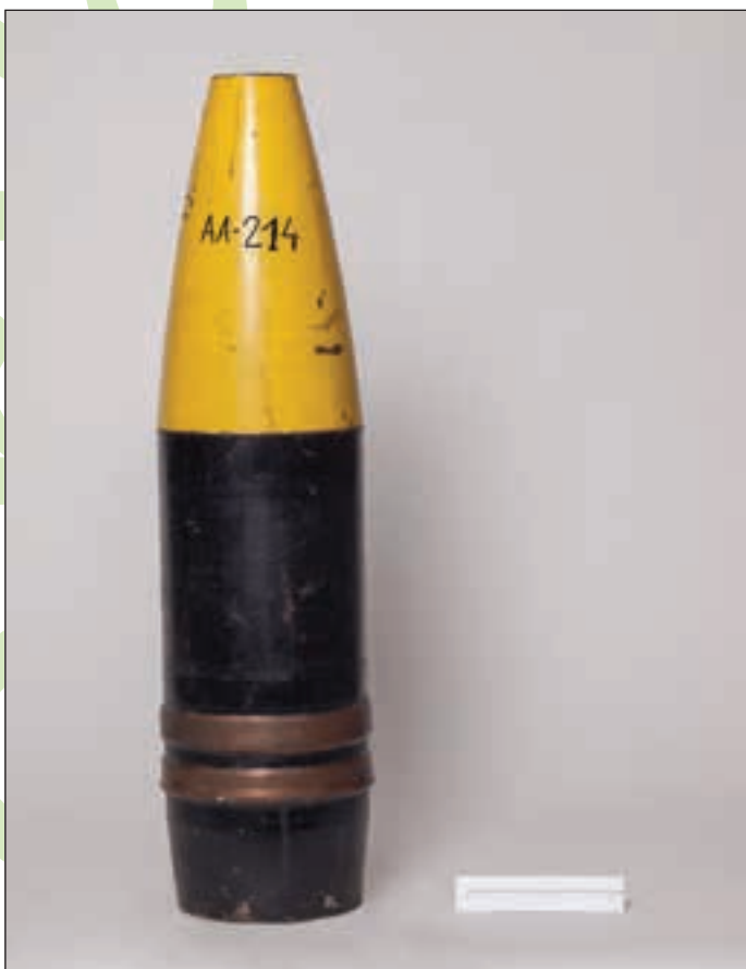
Figura 14. Proyectoil rompedor de 150 mm AA-214
